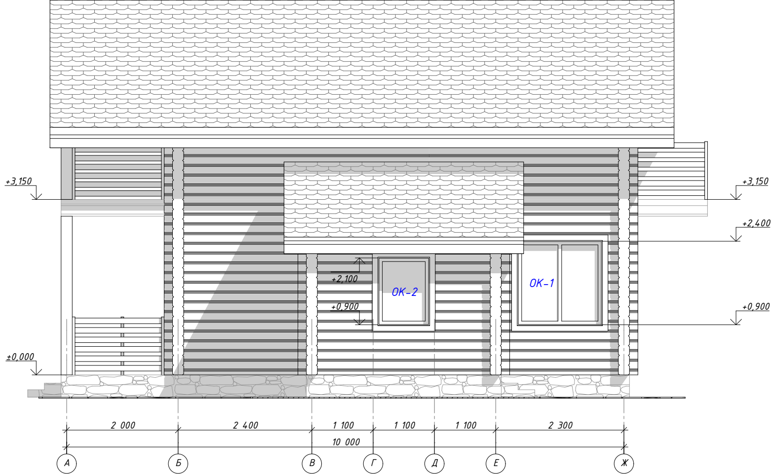
Фасад в осях А-Ж
